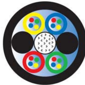
Кабель с волокнами в трубчатых модулях
